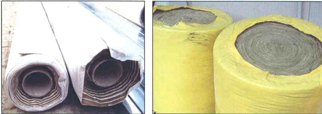
Fotografías 3 y 4 Tecsound SY50 y lana mineral
