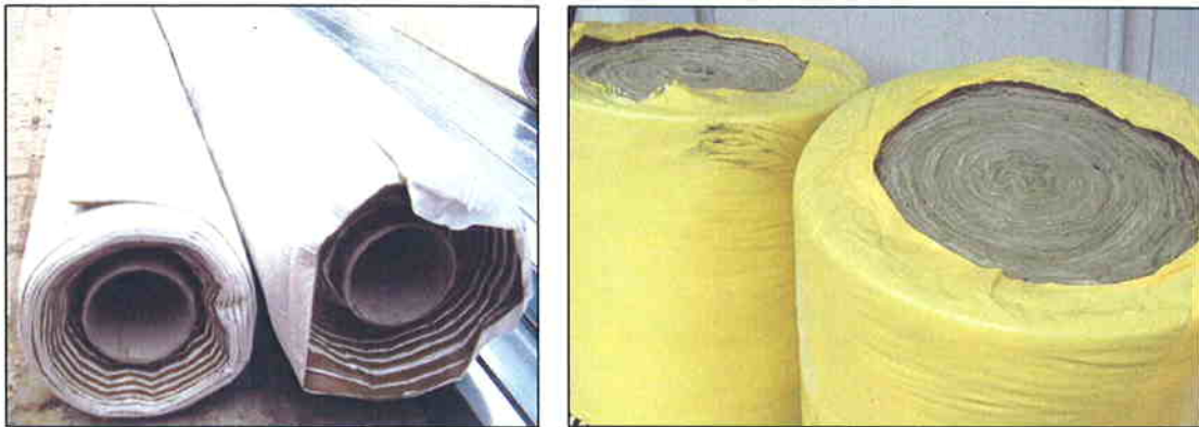
Fotografías 3 y 4 Tecsound SY50 y lana mineral
