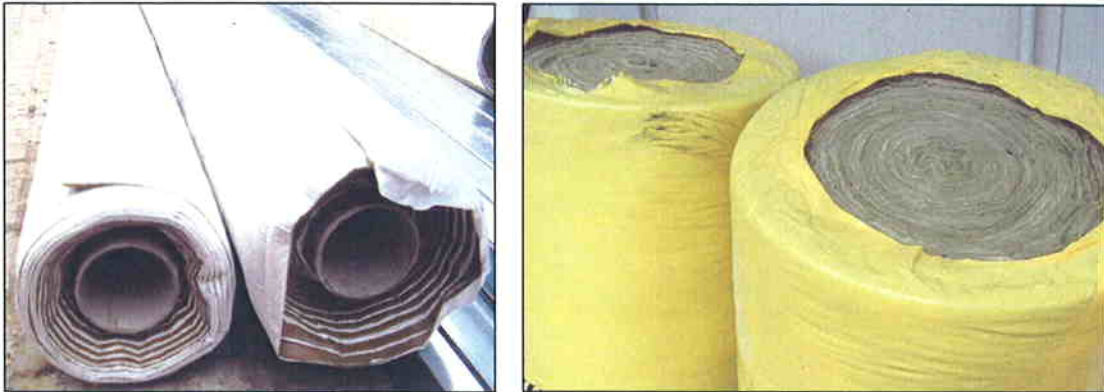
Fotografías 3 y 4 Tecsound SY50 y lana mineral
